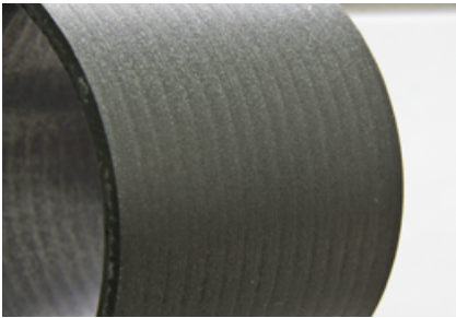
Bild 2. Präzises Elektrolechpaket in NO20
